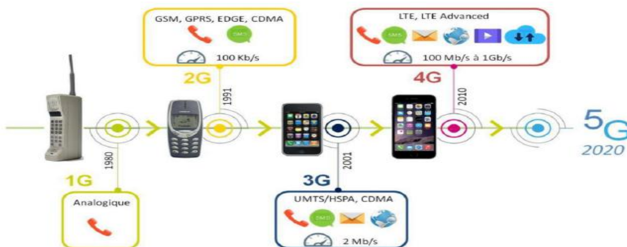
Figure I.1: Évolution des réseaux mobiles. [7]
