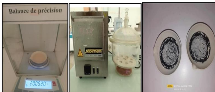
Figure 5. Détermination de la teneur en cendres
