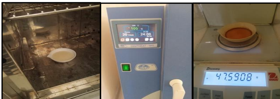
Figure 4. Détermination de l'Extrait Sec Total
