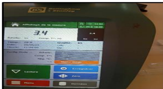
Figure 7. Détermination de la teneur en sucres par refractomètre
