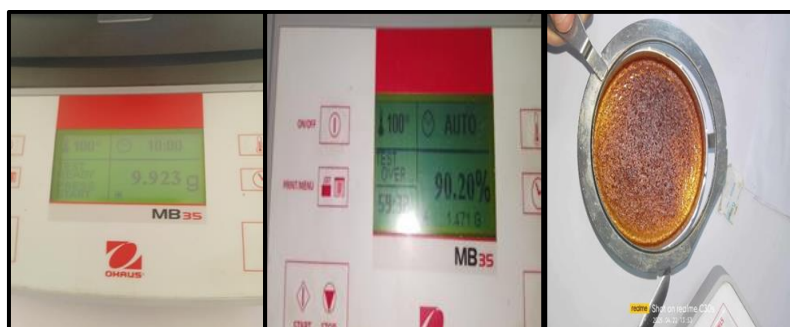
Figure 6. Détermination de taux d'humidité
