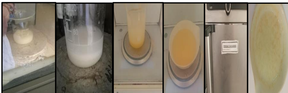
Figure 8. Étapes d'extraction des lipides par méthode de Folch
