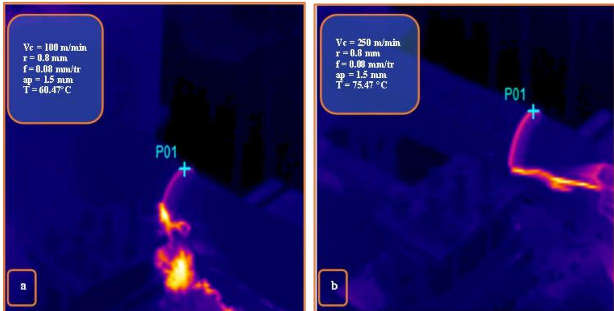
Figure III.8 Températures générées pour a)  $V_c = 100$  m/min et b)  $V_c = 250$  m/min.
