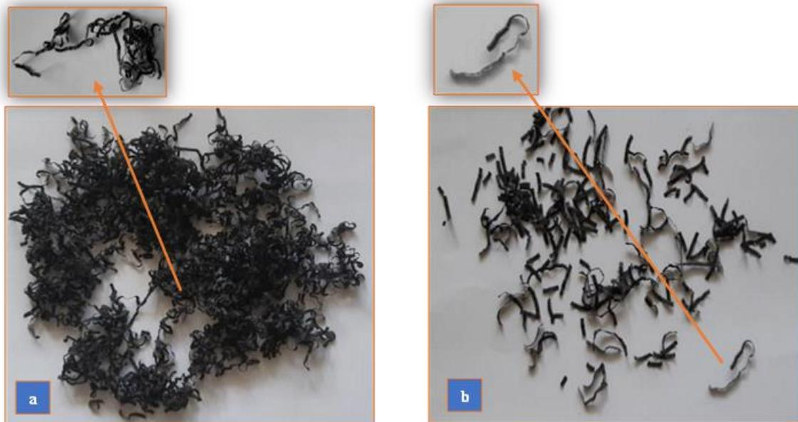
Figure III.2 Forme de copeau a)  $V_c = 100$  m/min et b)  $V_c = 250$  m/min.
