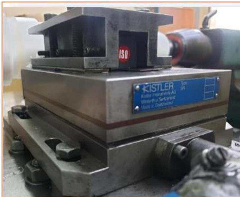
**Figure II.6** Dynamomètre (KISTLER9257 B).
