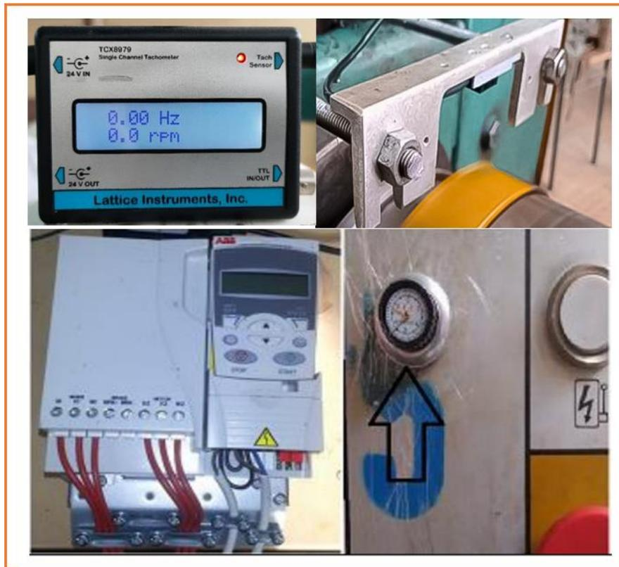
Figure II.2 Capteur et variateur de vitesse.
