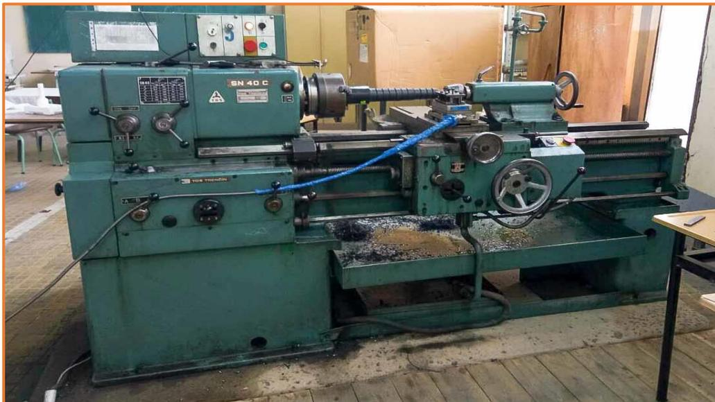
**Figure II.1** Tour parallèle modèle SN 40 C.
