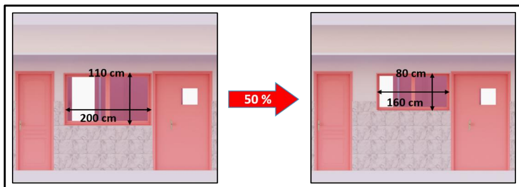
Figure 186 : l'intervention effectuée sur la taille de la fenêtre du mur entre le couloir et la chambre ; Source : Auteurs, 2025
