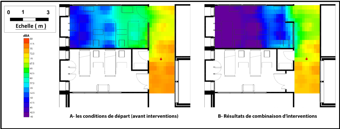
Figure 194 : Résultats de la simulation acoustique avant et après les interventions effectuées sur le mur séparatif entre le couloir et la chambre, représentés en carte du bruit ; Source : Auteurs, 2025
