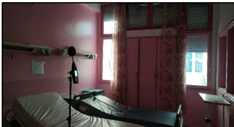
Figure 151 : Sonomètre fixé sur trépied à 1.5 du Sol
