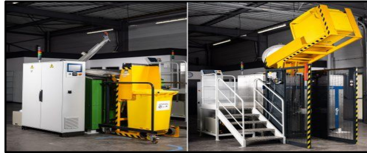
Figure 8 : Equipement de gestion, de tri et de stérilisation des déchets médicaux adopté à l'hôpital Whipps Cross à Leytonstone ; Source : https://www.bertin-medical-waste.fr/
