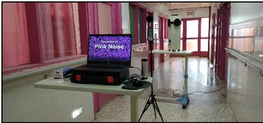
Figure 157 : Photo des mesures acoustique dans le couloir concernant l'isolation entre ce dernier et la chambre des patients
