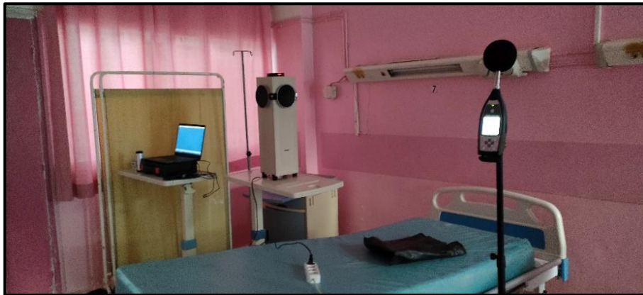
Figure 155 : Photo des mesures acoustiques dans la chambre d'émission concernant l'isolation entre chambre adjacentes
