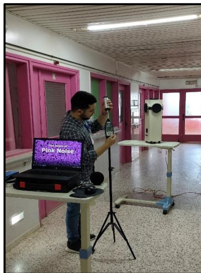
Figure 154 : instruments utilisés pour les mesures In-Situ d'isolation acoustique aérienne
