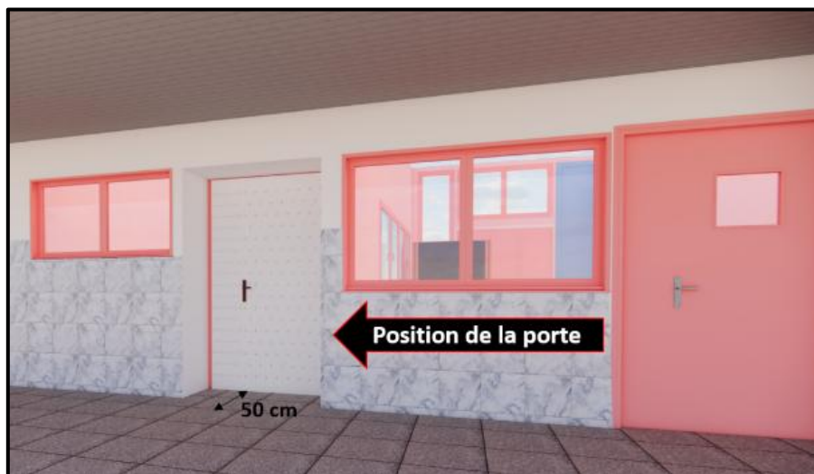
Figure 190 : l'intervention effectuée sur la position de la porte capitonnée ; Source : Auteurs, 2025
