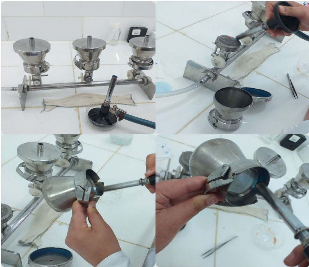
Figure 26: Les étapes d'analyses par filtration.
