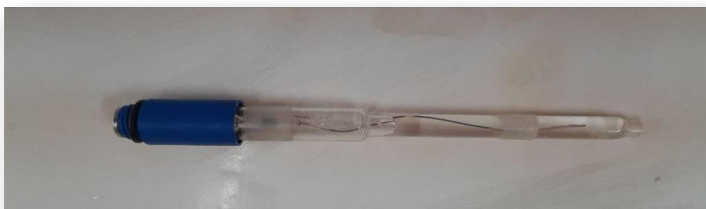
Figure III.2: Electrode de référence Ag/AgCl utilisée dans la partie expérimentale.
