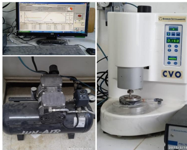
Figure III.10: Dispositif expérimentale de l'étude rhéologique.
