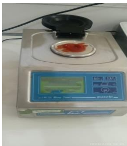
Figure III. 5: Détermination du Brix par réfractomètre.
