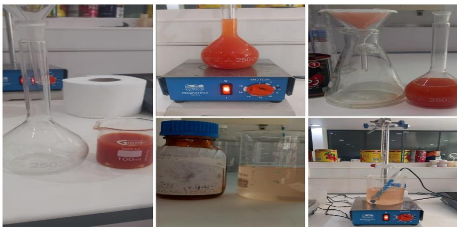
Figure III.8: Filtration et titration par NaOH.
