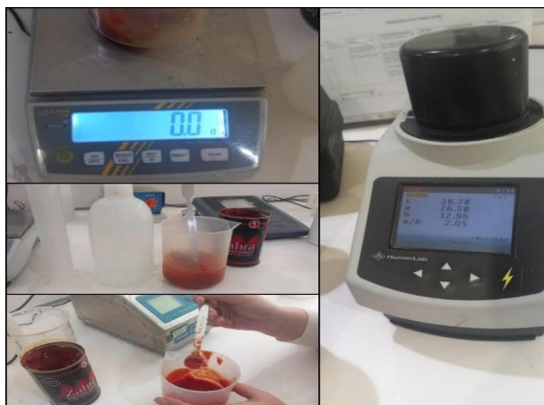
Figure III.6: Détermination de la couleur par spectrophotomètre.
