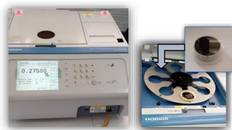
Figure III.11 : Appareillage de détermination de La teneur en soufre Selon la norme ASTM D-4292.
