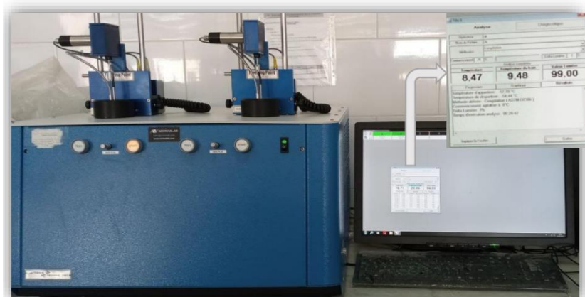
Figure III .5 : Appareil principal pour la détermination du point de congélation.
