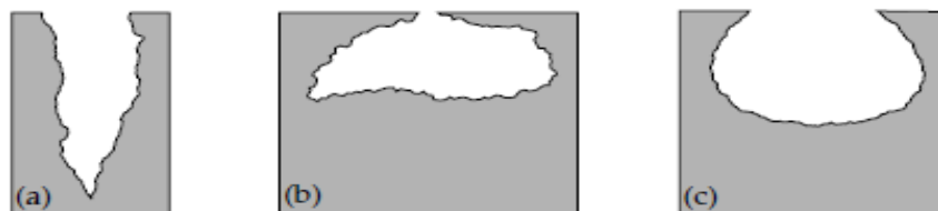
Figure II.5 : Formes de piqûres (a) cavité profonde (b) cavité caverneuse (c) hémisphérique [2].
