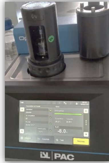
Figure III.7 Appareil mesurant le point de fumée.
