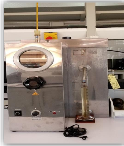
Figure III .1 : Appareillage de distillation ASTM, échelle laboratoire.
