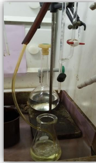
Figure III .2 : Appareillage de Mesure de l'acidité totale.
