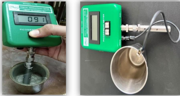
Figure III. 8 : Appareil de mesure de conductivité électrique.
