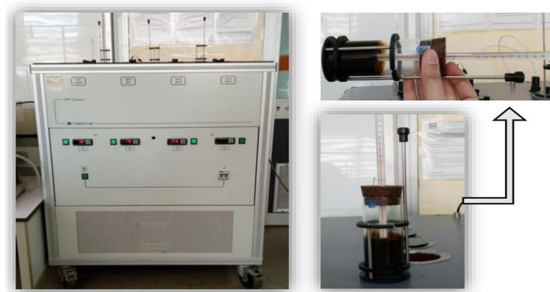
Figure III.9 : Appareillage de détermination de point d'écoulement par la méthode d'essai ASTM D 97.
