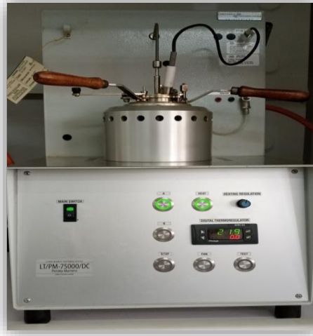
Figure III.4 : Appareillage point d'éclair semi-automatique vase clos (PM).
