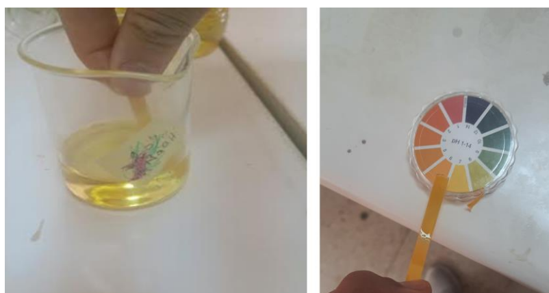
Figure II.8. Mesure du pH à l'aide d'un papier pH.
