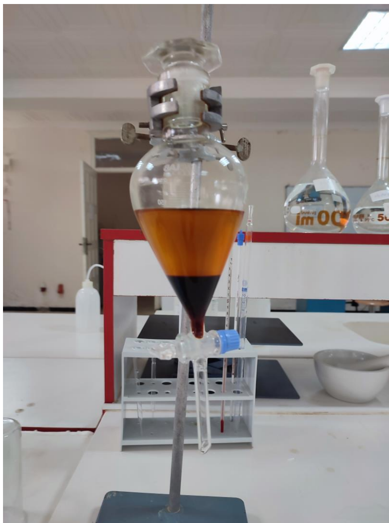
Figure II.4. Séparation des phases glycérol et biodiesel.
