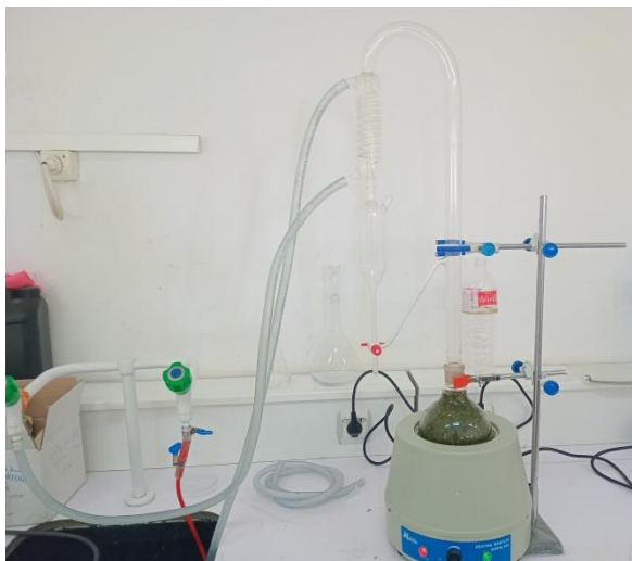
Figure 15: Appareil d'hydro-distillation type Clevenger (photo personnel).
