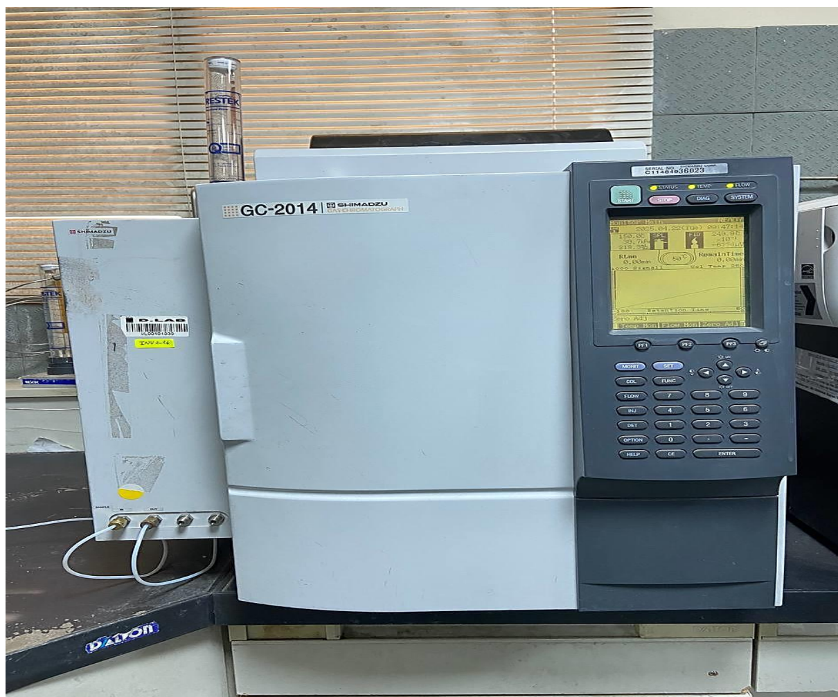
Figure III.1 : Appareil CPG (SHIMADZU série C114849) utilisé (Laboratoire d'analyse de GPL 2).
