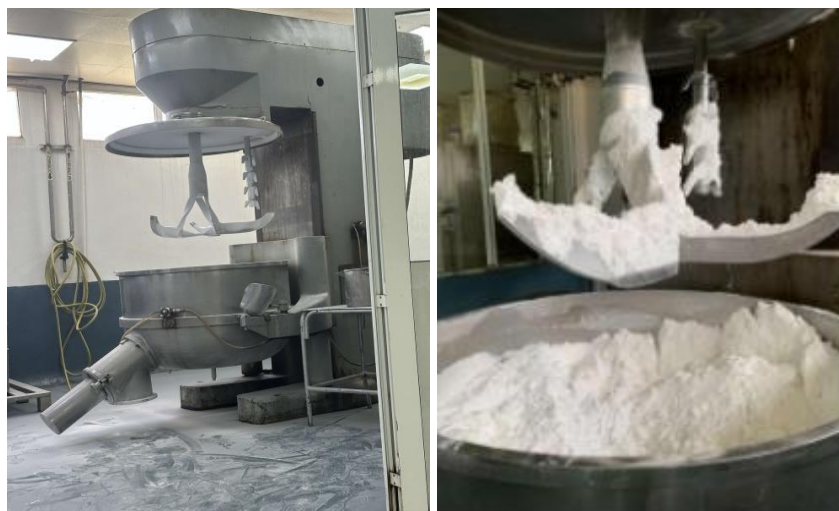
Figure 16: Préparation du mélange à sec dans la Collette.
