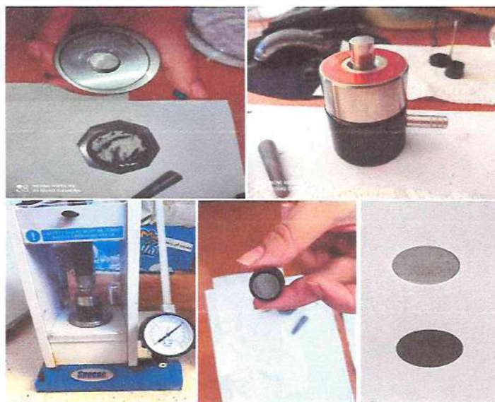
Fig. IV. 10 Etape de compression du mélange homogène KBr + échantillon.
