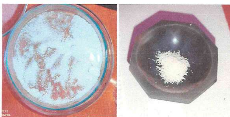
Fig. IV. 7 Préparation du KBr dans le mortier avant incorporation de l'échantillon.
