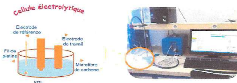
Fig. IV. 3 Montage expérimental à trois électrodes utilisées pour les mesures électrochimiques lors de ce travail de mémoire (analyse).
