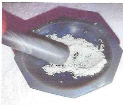
Fig. IV. 9 Mélange homogène et légèrement humide de KBr et de la matière active après broyage manuel.
