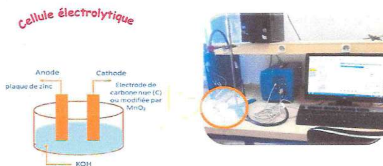
Fig. IV. 4 Montage expérimental à deux électrodes utilisées pour les mesures électrochimiques lors de ce travail de mémoire (analyse).
