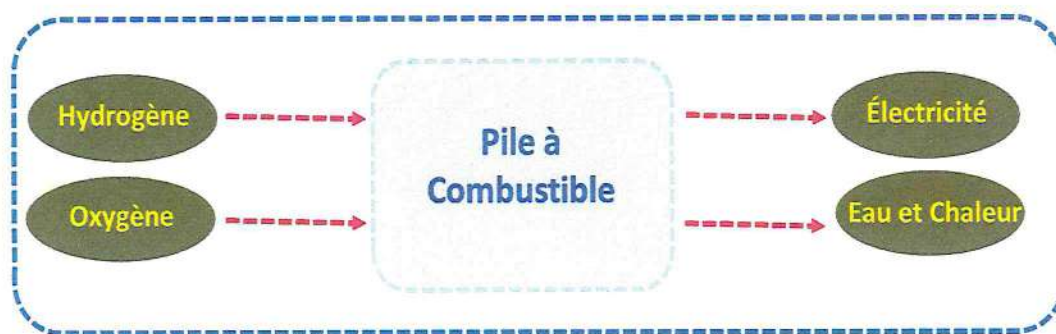
Fig. I. 8 Schéma de principe de conversion directe en électricité.
