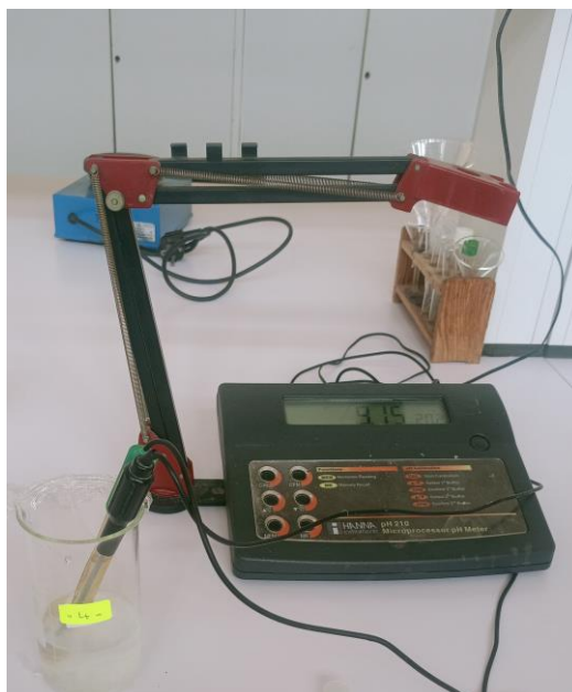
Figure II.22. Mesure du pH avec un pH-mètre.
