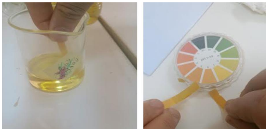
Figure II.4. Mesure du pH à l'aide d'un papier pH.
