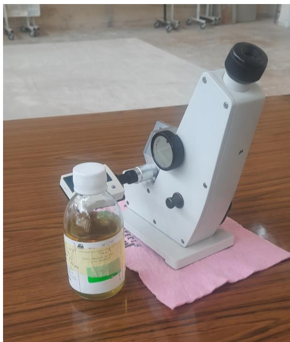
Figure II.8. Réfractomètre utilisé pour la mesure de l'indice de réfraction
