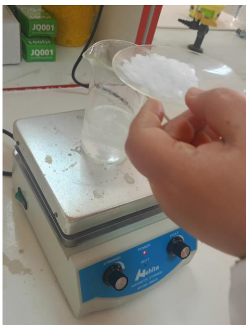
Figure II.14. Préparation de la solution de NaOH
