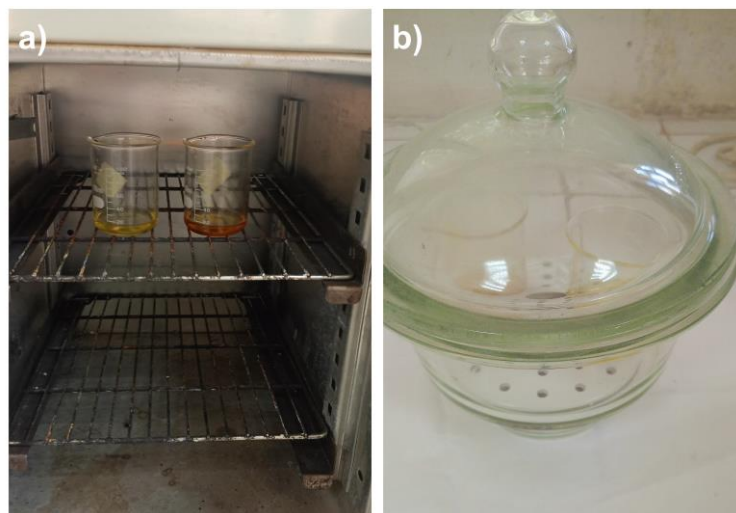
Figure II.3. a) Séchage des échantillons d'huile dans l'étuve ; b) Refroidissement des échantillons dans le dessiccateur.
