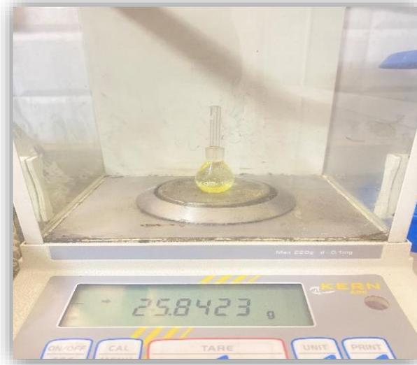
**Figure 24** : mesure de la densité relative à 20 C (photo originale 2025)
