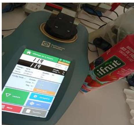
Figure 3: Mesure du degré Brix d'un jus à l'aide d'un réfractomètre (prise personnel)
