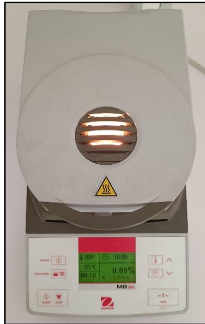
Figure 19. La mesure de teneur en eau par un analyseur d'humidité (Photo prise par BOUTARFA.Y.2024)
