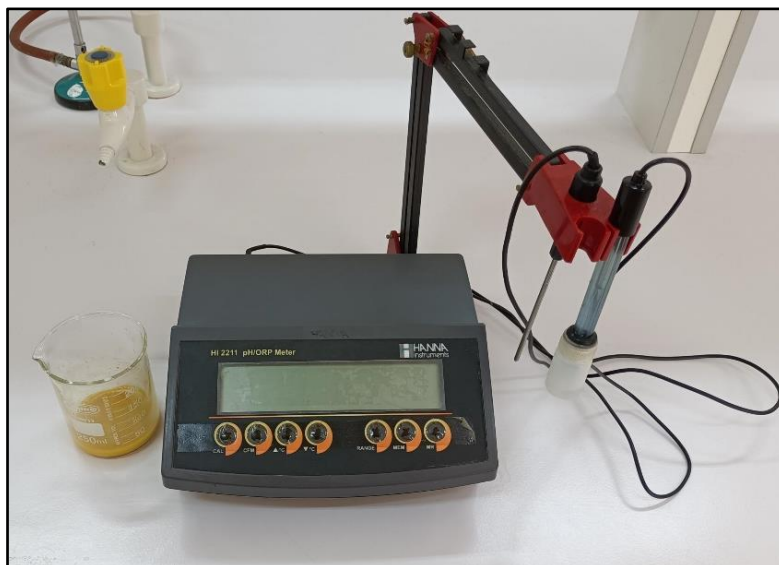
Figure 20. La mesure de pH par un pH-mètre (Photo prise par BOUTARFA.Y.2024)
