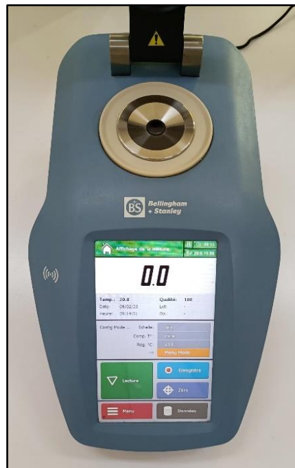
Figure 22. La mesure de taux de Brix par une Réfractométrie (Photo prise par DERGHOUM.I.2024)
