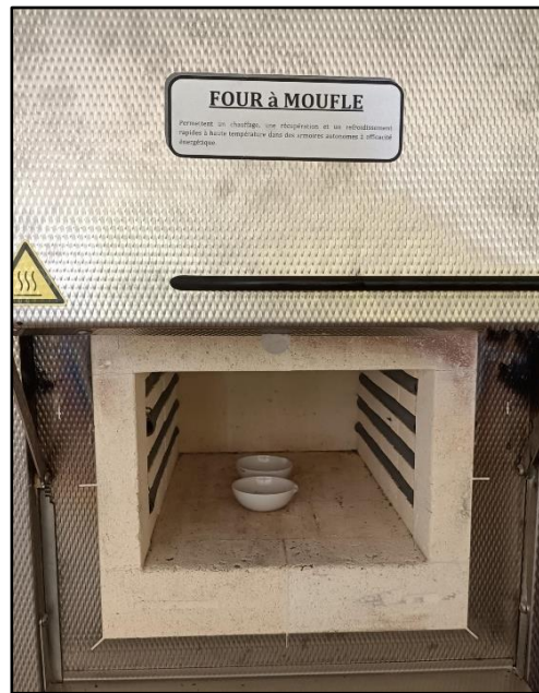
Figure 21. La mesure de taux de cendre par un Four à moufle réglé à 600 (Photo prise par DERGHOUM.I.2024)
