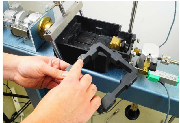
Figure 4.16 Insérer le support carré noir dans le chariot
