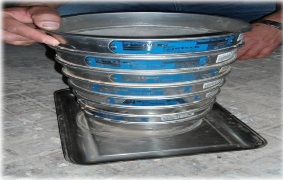
Figure 2.6. Série de tamis de Laboratoire
