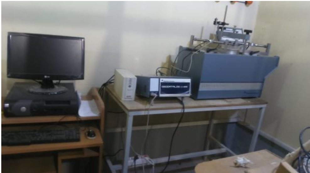
Figure 3.12. Vue d'ensemble d'équipement de cisaillement
