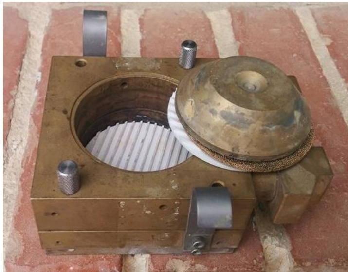
Figure 3.8. La boîte de cisaillement circulaire
