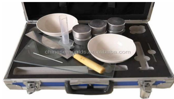
Figure III.18. Appareillage nécessaire pour déterminer W_p .
