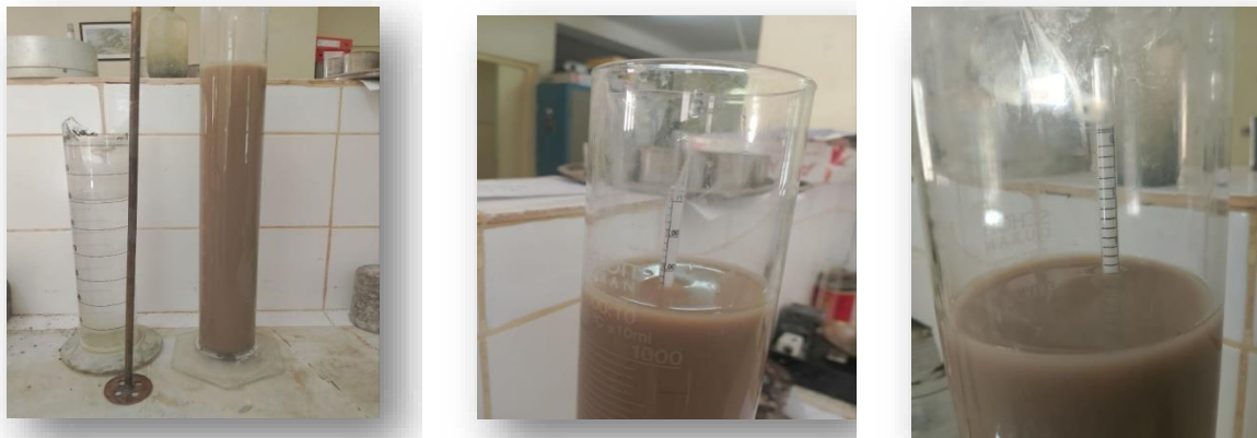
Figure III.12. L'analyse granulométrique par sédimentométrie.
