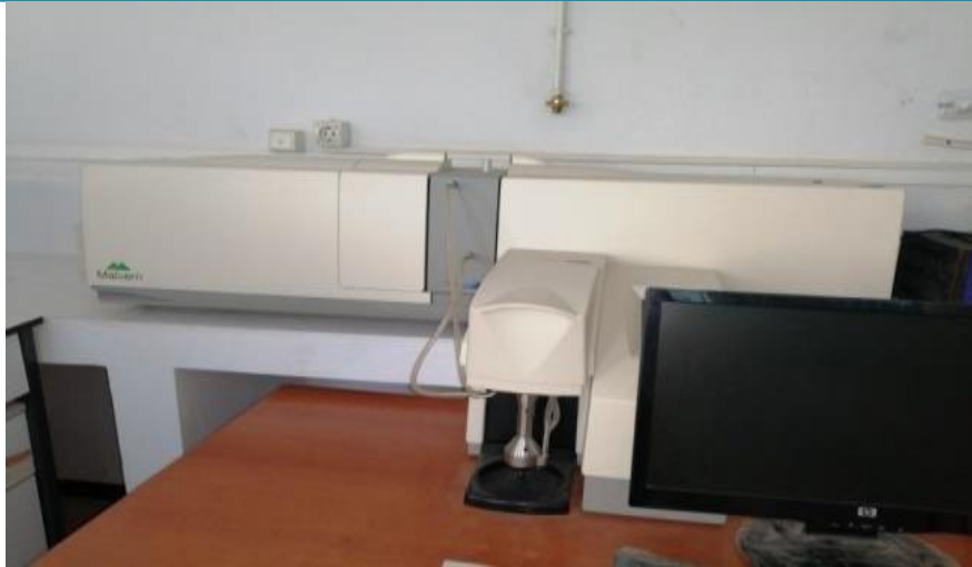
Figure III.8. Appareil d'analyse granulométrique. Mastersizer 2000 Malvern.
