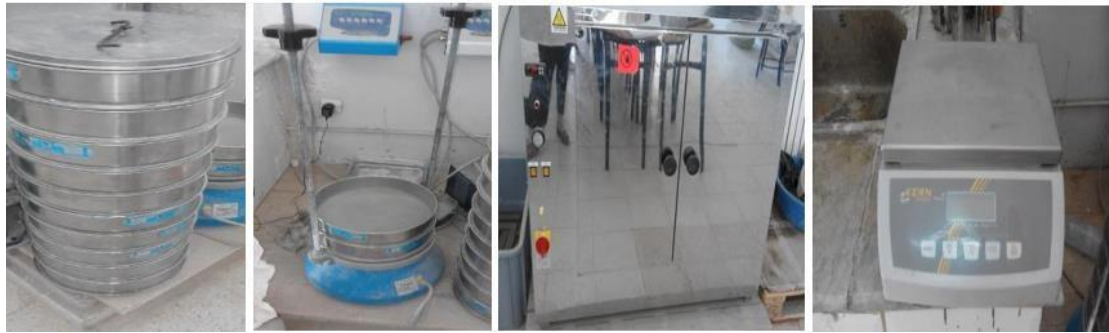
Figure III.11. L'analyse granulométrique par tamisage.
