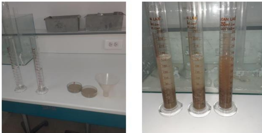
Figure III.6. Masse volumique absolue, méthode des éprouvettes.
