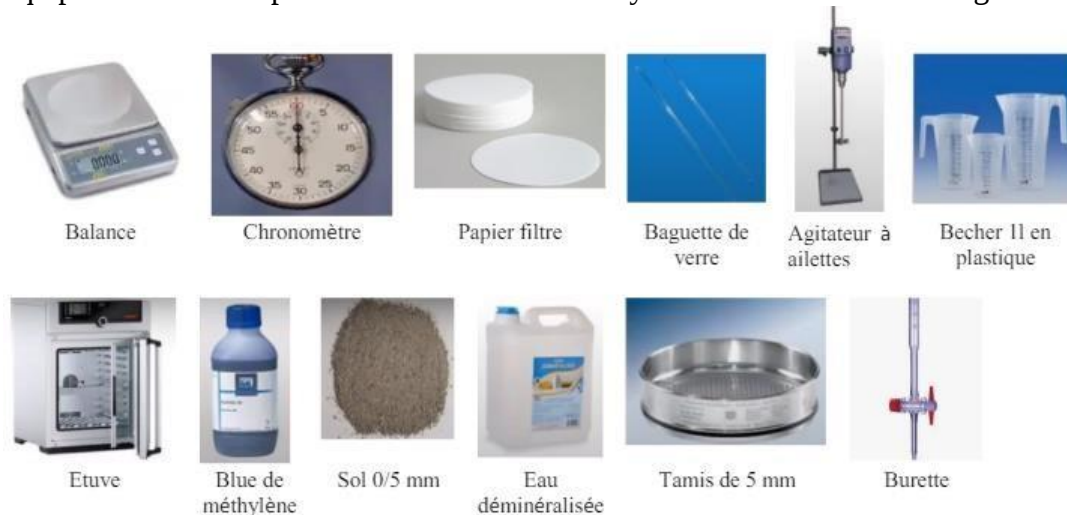
Figure III.4. Les équipements utilisés pour l'essai au bleu de méthylène.
