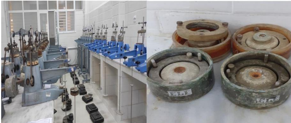
Figure III.28. Appareillage de l'essai Oedométrique.
