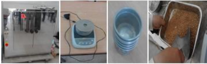
Figure. III.10. Equipements utilisés pour l'essai de teneur en eau.
