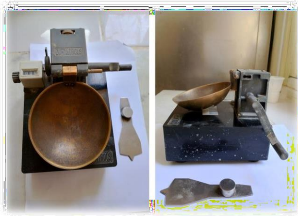
Figure III.15. Appareil de Casagrande.
