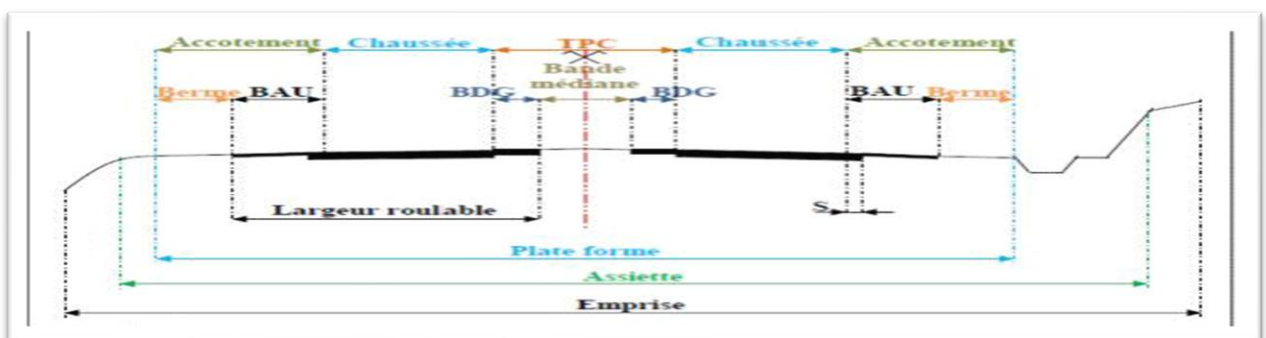
Figure II .13 profil en travers type
