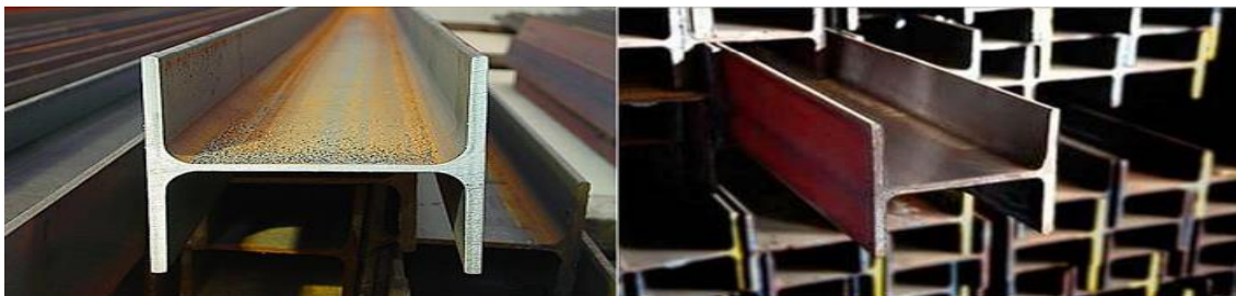
Figure III. 6: Poutrelles laminées courantes
