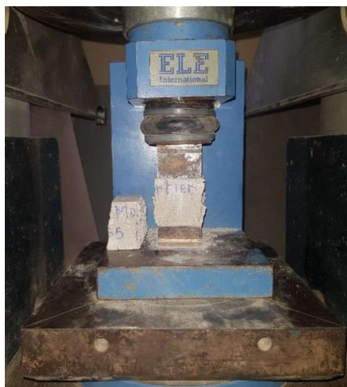
Photo IV.6. Essai de compression sur éprouvette 4 \times 4 \times 4 \text{ cm}^3
