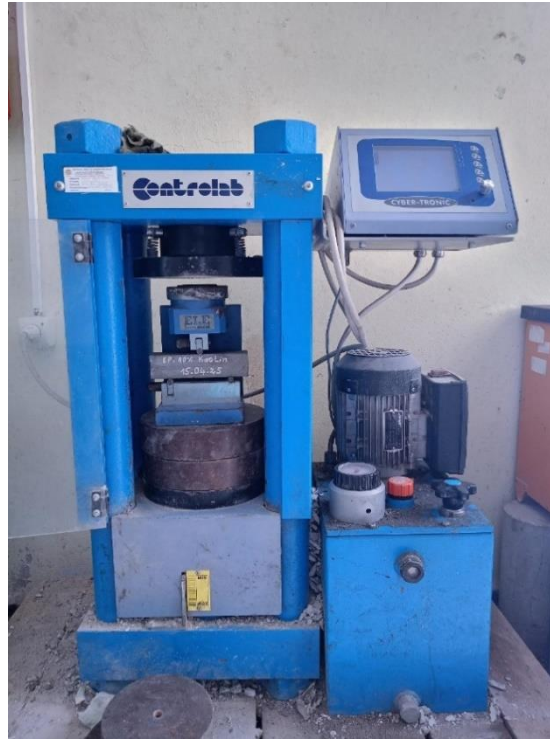
Photo IV.7. Eprouvette de mortier avec 15% de kaolin sous la presse hydraulique
