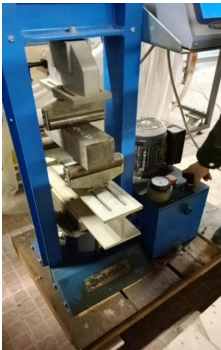
Photo IV.5. Essai de flexion 3 points sur éprouvette 4 \times 4 \times 16 \text{ cm}^3
