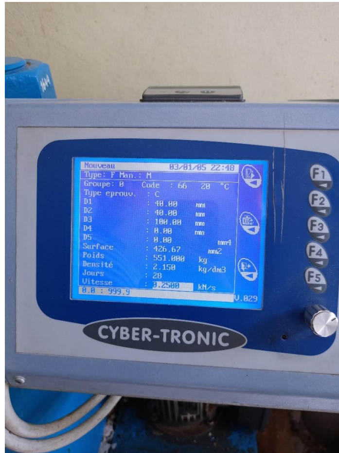
Photo IV.8. Tableau d'affichage de l'appareil d'essai. Vitesse de chargement adoptée = 0.25 KN/s
