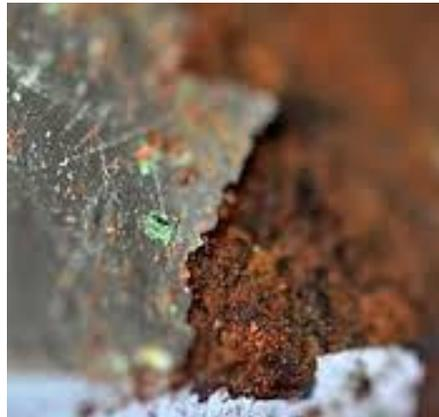
**Figure 2.23 :** Corrosion par crevasses [18].
