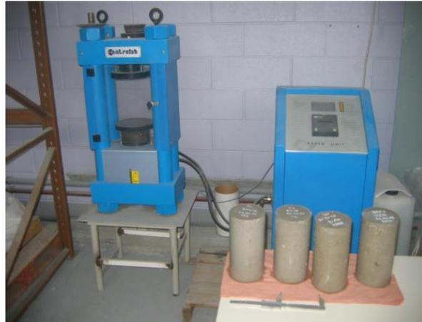
Figure 1.24: Machine de l'essai la compression [52].
