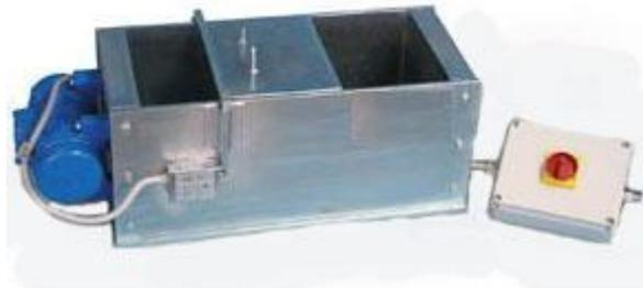
Figure 1.23 : Photo d'un maniabilimètre LCPL [20].
