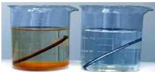
(a) sans inhibiteur de corrosion    (b) avec inhibiteur de corrosion
