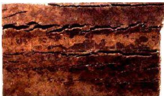
**Figure 2.25 : Fissures de la corrosion sous contrainte CSC [35].**
