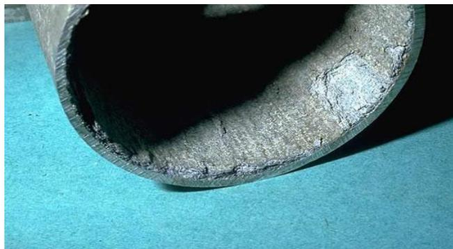
**Figure 2.24 : Corrosion sélective [11].**
