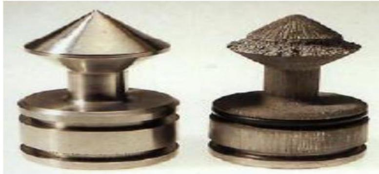
**Figure 2.28 :** Corrosion-érosion due à de fortes vitesses de circulation du fluide corrosif [45].
