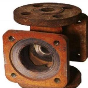
**Figure 2.18 :** Corrosion générale (rouille) d'une pièce en acier [39].
