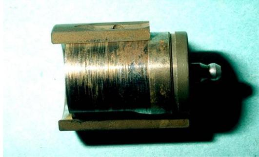
**Figure 2.26 :** Corrosion par frottement d'une pièce [45].
