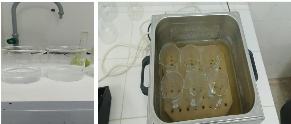
**Figure 4. 19:** Préparation de l'échantillon pour analyser Nitrate ( $\text{NO}_3^-$ )
