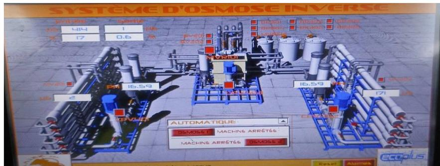
**Figure 3. 1:**Schéma du système d'osmose inverse installé à la station de dessalement d'Ouled-Djellal
