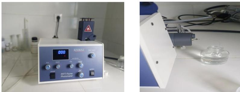
**Figure 4.13:** Spectromètre utilisé pour la mesure des cations  $\text{Ca}^{2+}$ ,  $\text{Na}^+$  et  $\text{K}^+$
