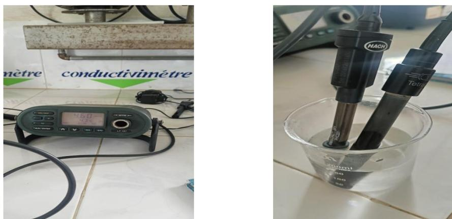
**Figure 4. 5:** Conductimètre utilisé pour l'évaluation de la conductivité de l'eau.
