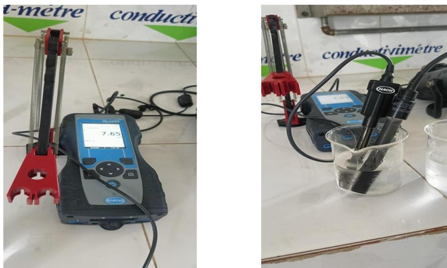
Figure 4. 3: Appareil pH-mètre utilisé pour la mesure du potentiel hydrogène
