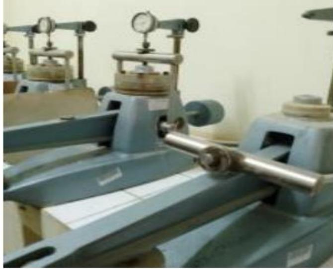
**Figure 5. 18 :** Représentation de la machine œdométrique de laboratoire de LNHC à GUELMA.
