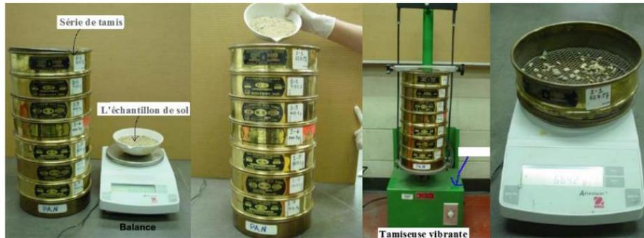
Figure 4. 3 : L'analyse granulométrique par tamisage.
