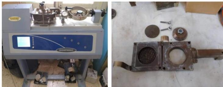
**Figure 4. 14 :** Equipements utilisés pour l'essai de cisaillement.
