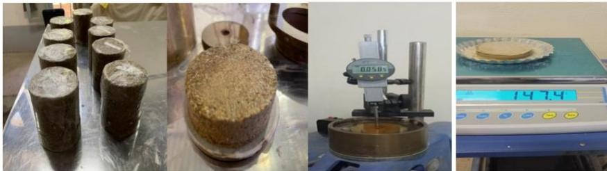
**Figure 4. 15 :** Préparation des éprouvettes pour l'essai œdométrique.
