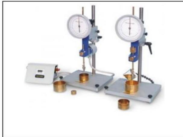
Figure 4. 9 : Méthode au cône de pénétration.
