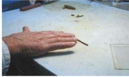
Figure 4. 10 : Limite de plasticité  $w_p$  par la méthode au rouleau.
