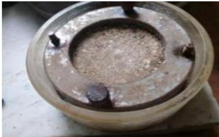
**Figure 5. 19 :** Cellule de consolidation
