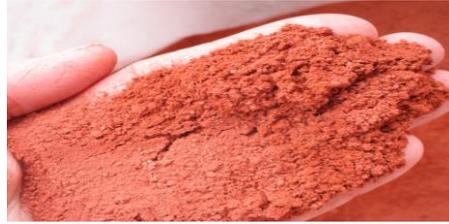
Figure 4. 2 : L'ajout utilisé (Poudre du déchet de brique rouge).
