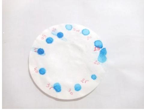
*Figure III.18 Résultats de l'essai à la tâche de poudre de céramique*
