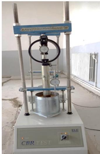
*Figure III.24 Appareil de CBR*
