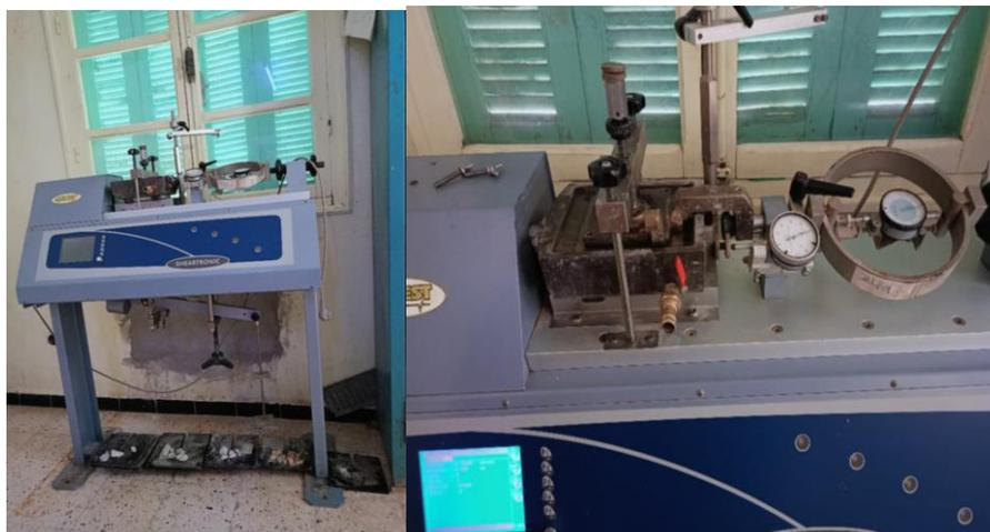
Figure III.21 Appareil de cisaillement direct
