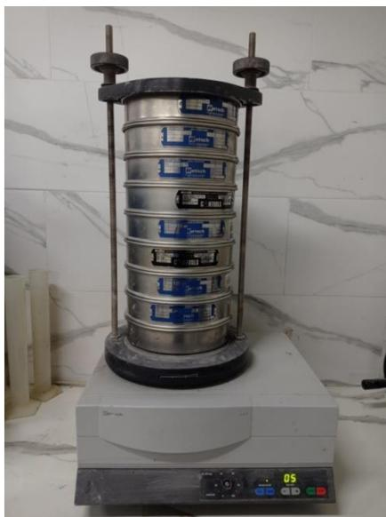
Figure III.2 Série de tamis et tamiseuse électrique
