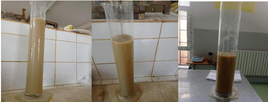
Figure III.7 Essai d'Analyse granulométrique par sédimentométrie
