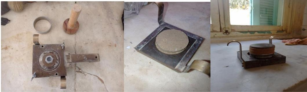
Figure III.23 Préparation de l'échantillon pour l'essai de cisaillement
