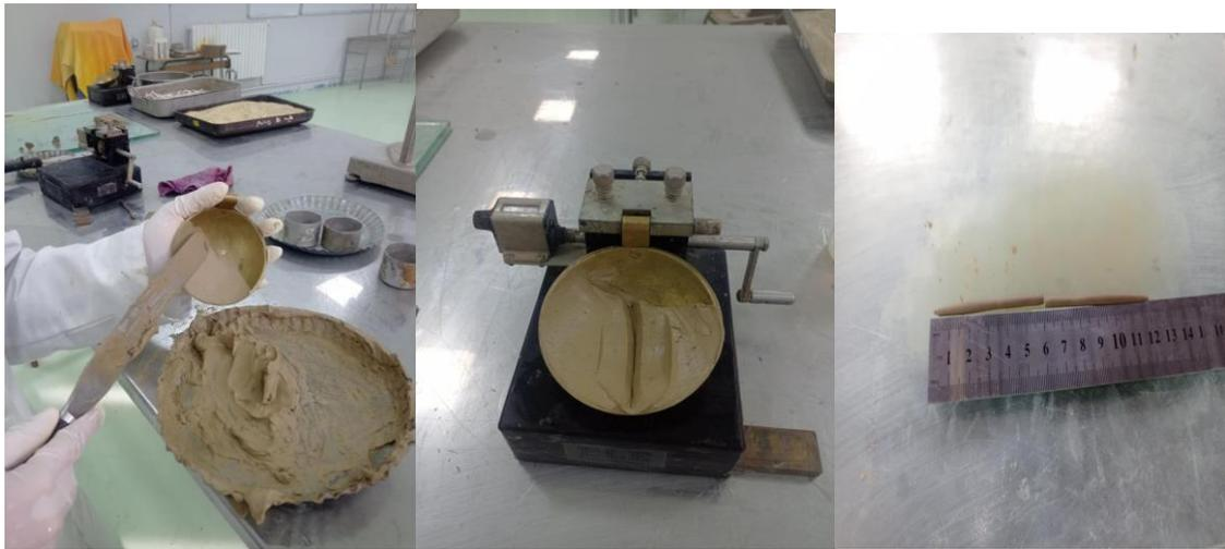
**Figure III.11** Essai limites d'Atterberg
