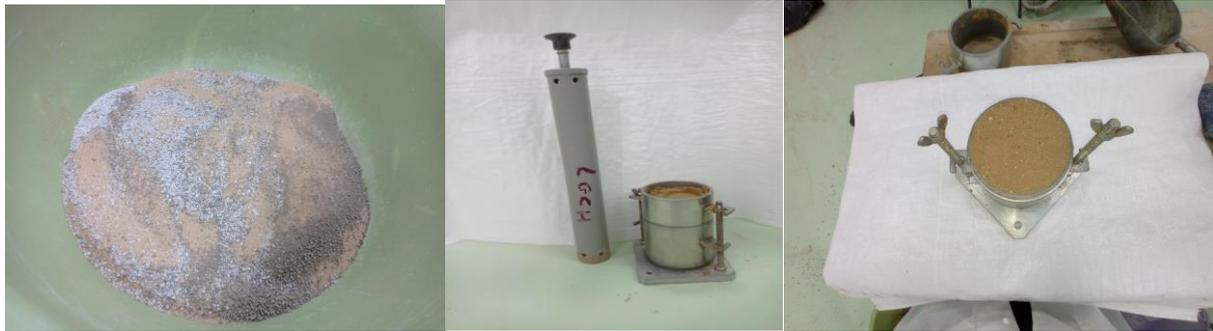
Figure III.19 Essai Proctor normal des mélanges
