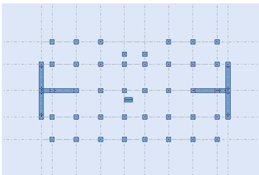
**Figure IV.3 :** Vue en plan de la disposition des voiles au niveau 00.
