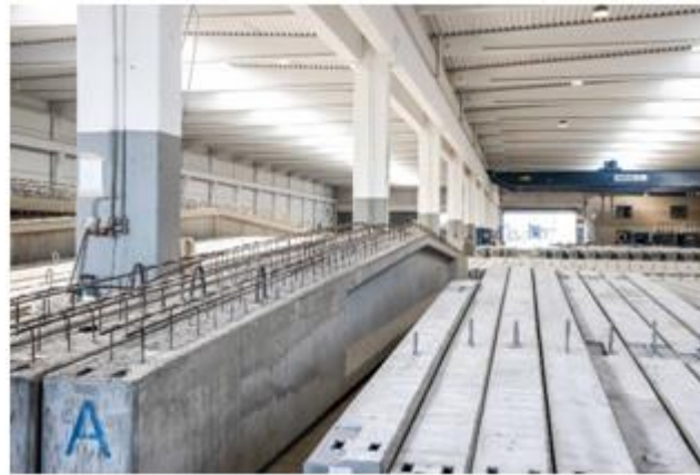
Figure II.13 : Poutres à hauteur variable [66].
