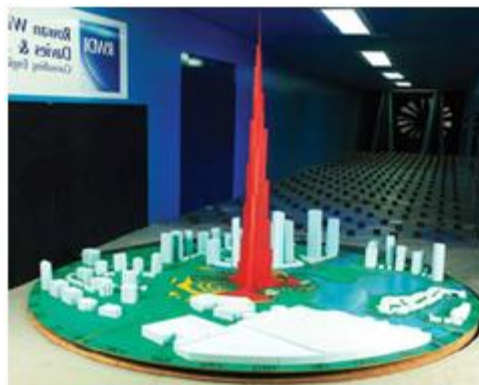
Figure IV.8 : Maquette pour le test en soufflerie du Burj Khalifa [21].
