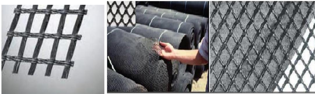
Figure I.11: Exemple de géogrille.
