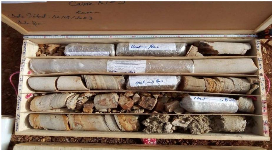
Figure IV.2 Photographie de la caisse à carottes BH-T2-S1/20.00-25.00 [1]
