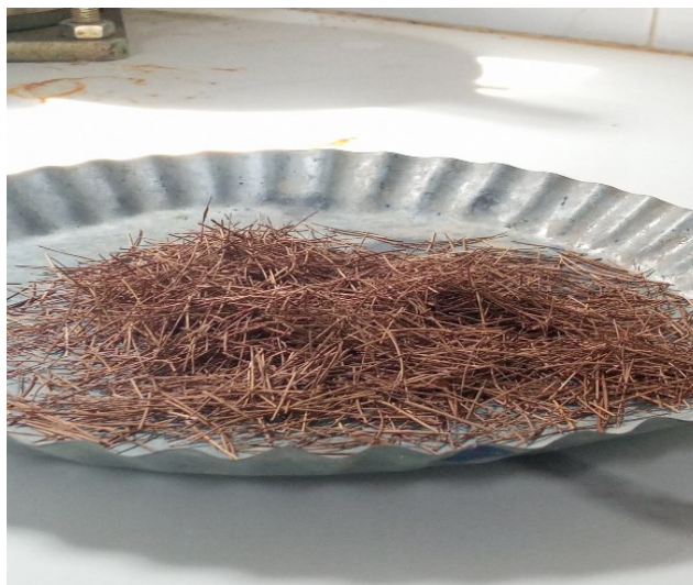
Figure II.15 : Fibre découpé entre 15 et 20 mm
