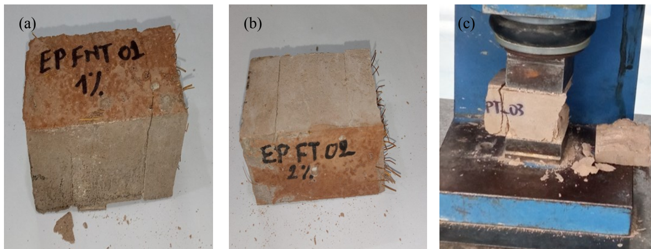
Figure III.2 : Mode de rupture en compression des spécimens ; (a) EPFNT-1,0, (b) EPFT-2,0, (c) : EPC
