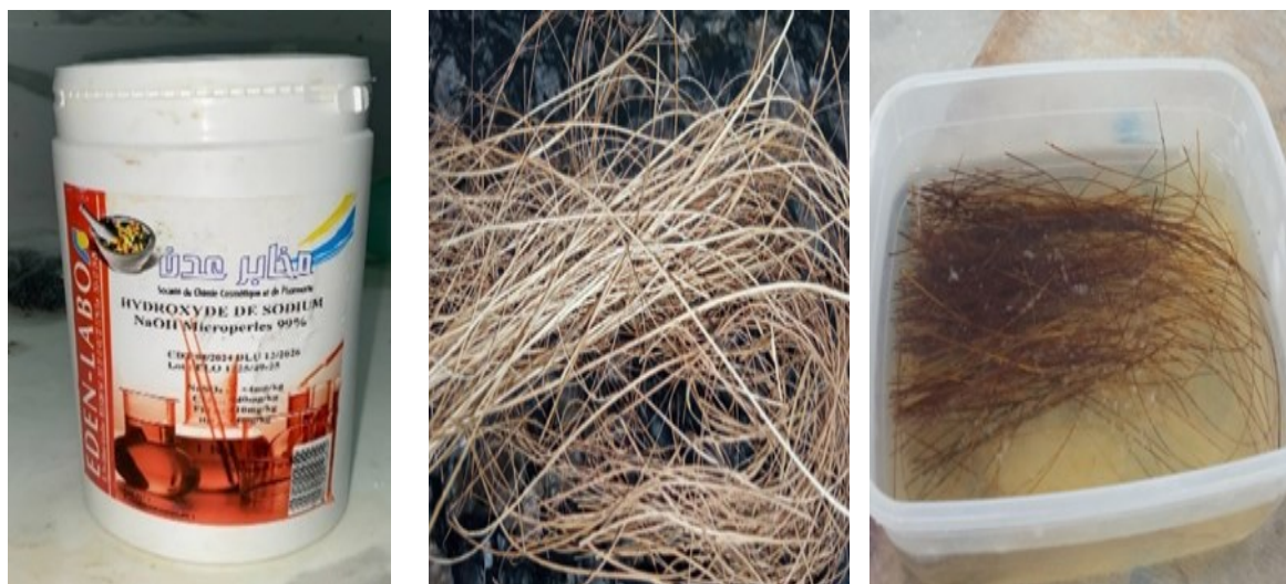
Figure II.14 : Traitement des fibres.
