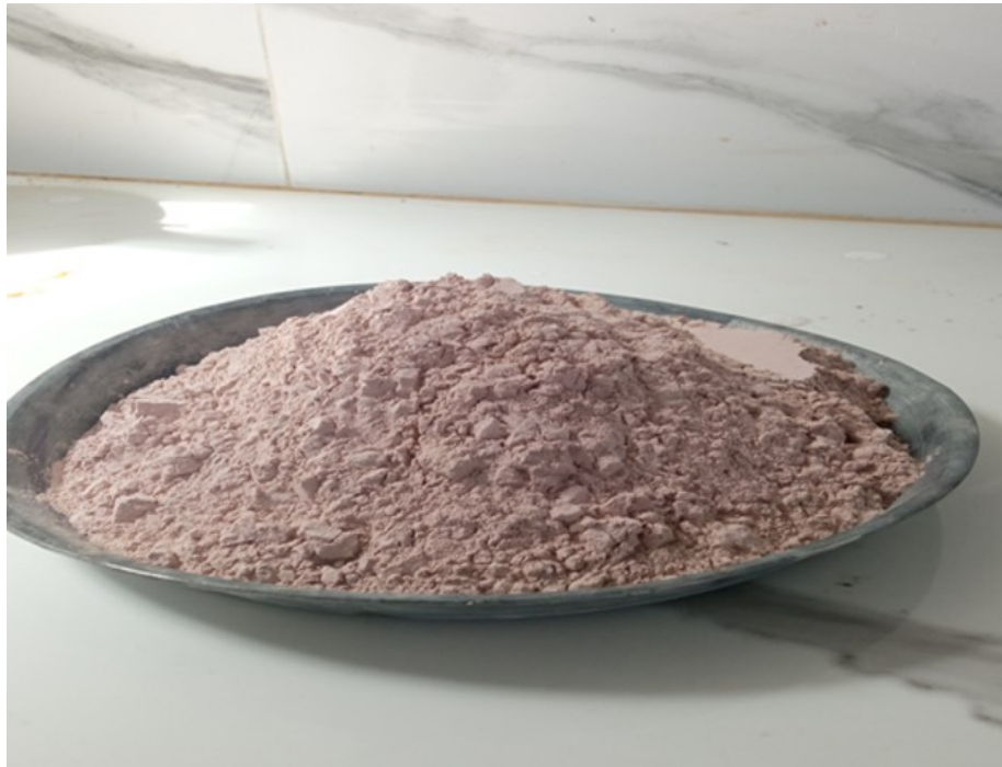
Figure I.6 : Poudre de métakaolin après calcination à haute température.
