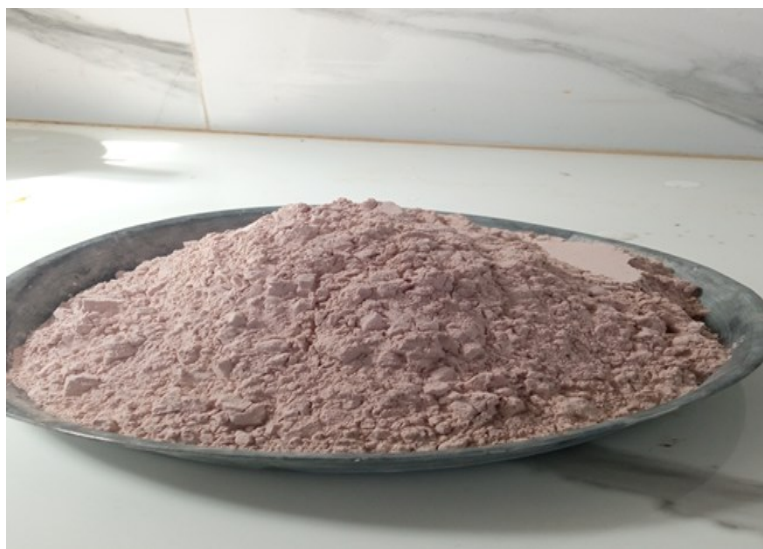
Figure II.2 : Echantillon du métakaolin après transformation thermique à 750 °C.
