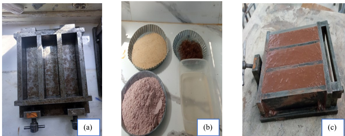
Figure II.16 : (a) Moule employé, (b) matériaux utilisés et (c) Arasage du mortier.
