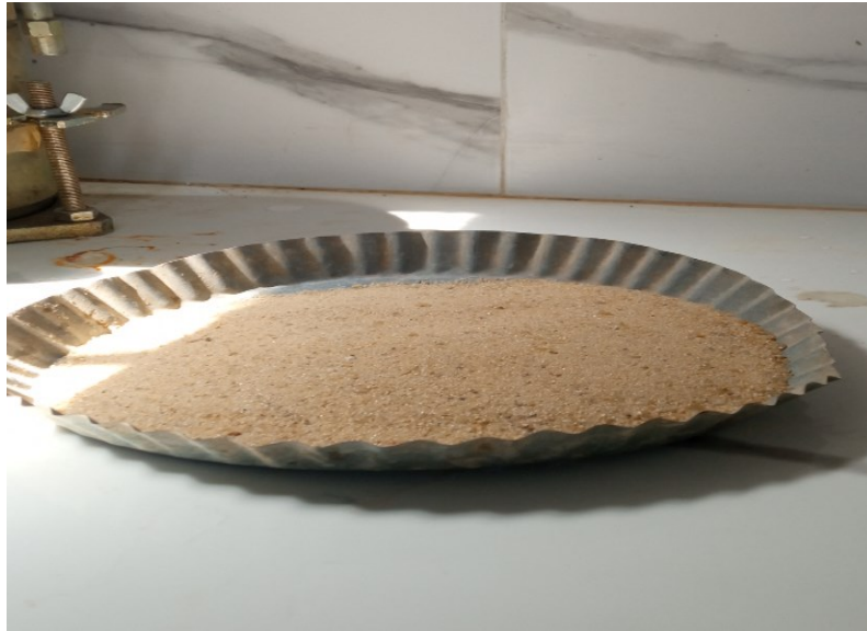
Figure II.5 : Sable de rivière utilisé dans le mortier géopolymère.
