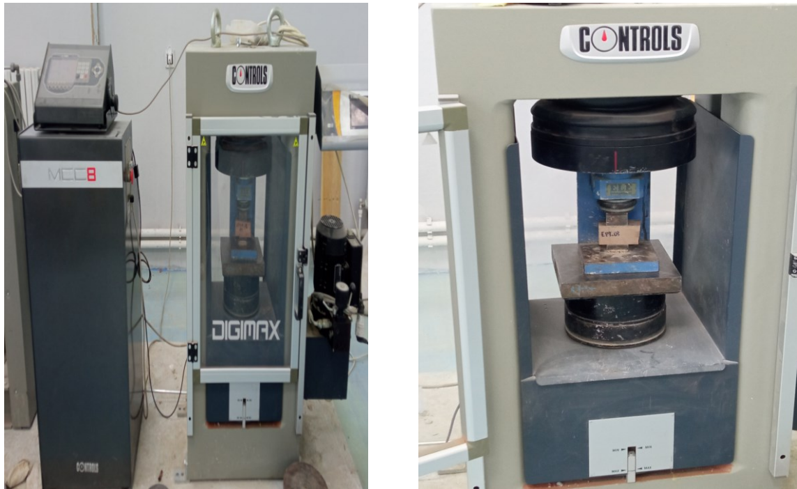
Figure II. 22 : La presse électromécanique de l'essai de compression.
