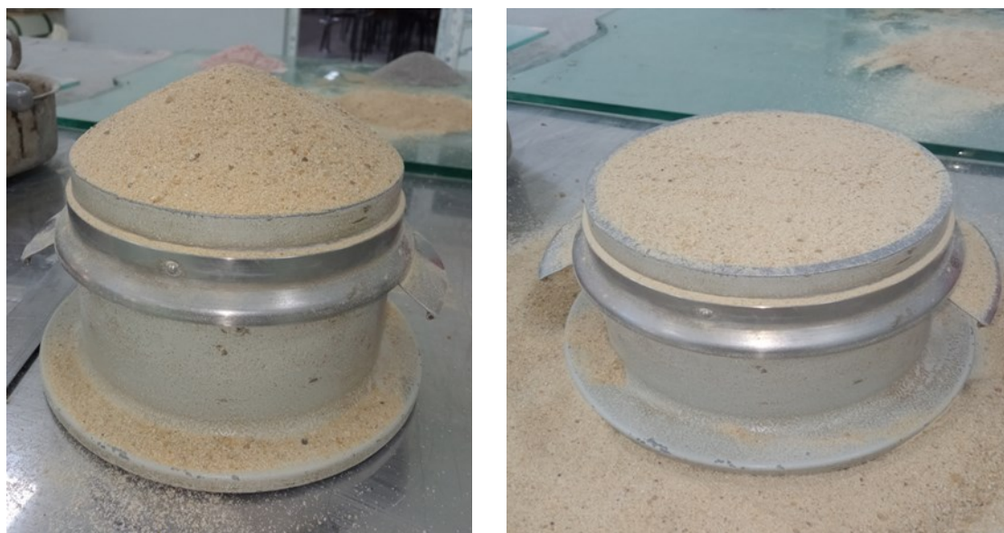
Figure II.8 : Essai de la masse volumique apparente.
