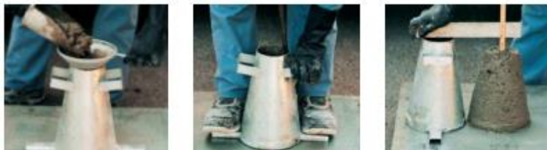
Figure I.5 : Mesure de l'affaissement du béton au cône d'Abrams. [18]
