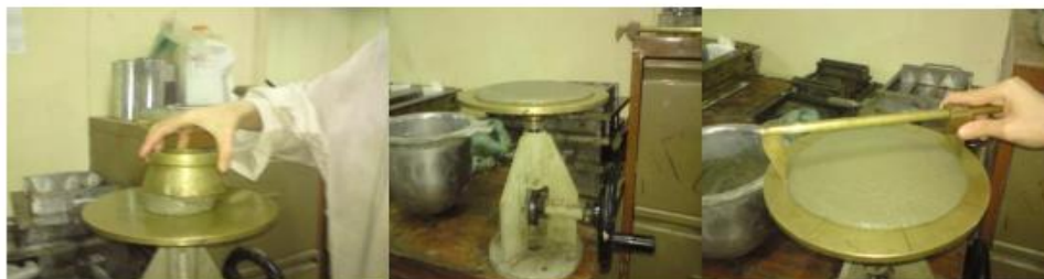
Figure I.6 : Mesure de l'étalement d'un mortier
