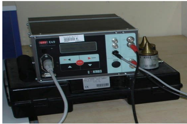
Figure I.9 : Appareille d'essai ultrasonique.
