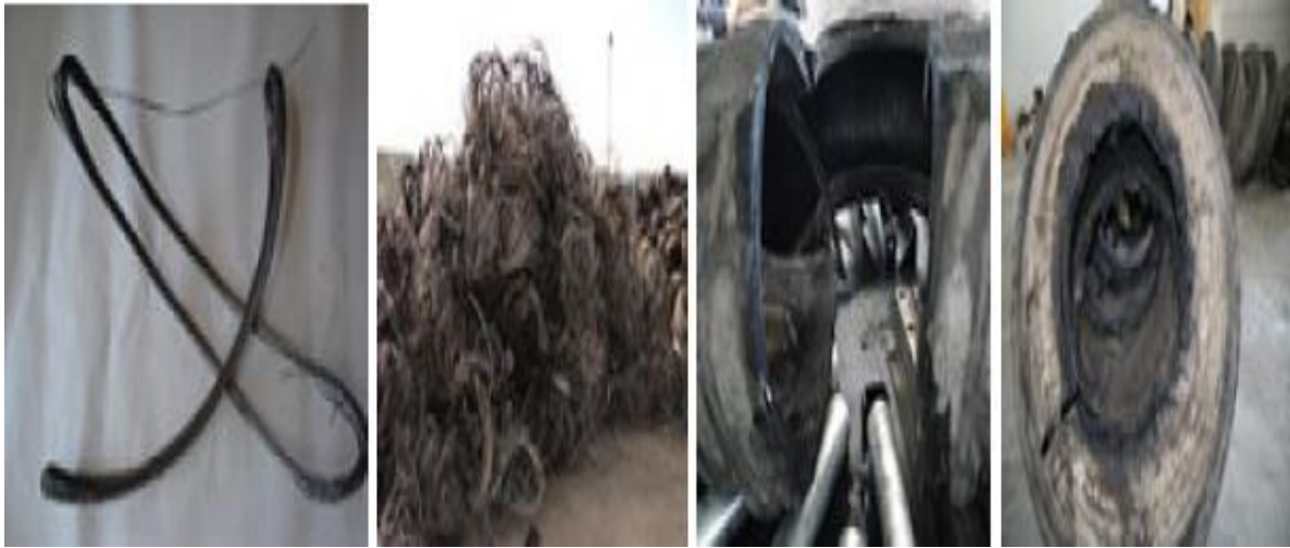
Figure II.15 : Récupération de l'acier (Séparation).
