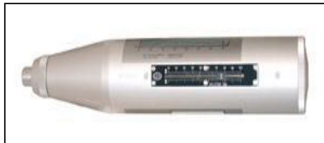
Figure I.8 : Appareil d'essai de scléromètre.
