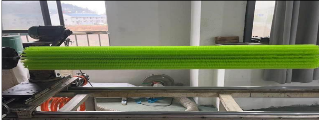
Fig. 18 : Brosse de nettoyage pour panneaux solaires
