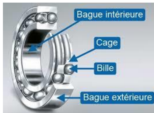
Figure 2.8: Composants d'un roulement à billes.
