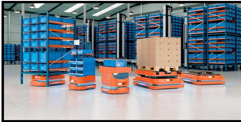
Figure I .21 : Robots mobiles autonomes(AMR) naviguant dans un entrepôt
