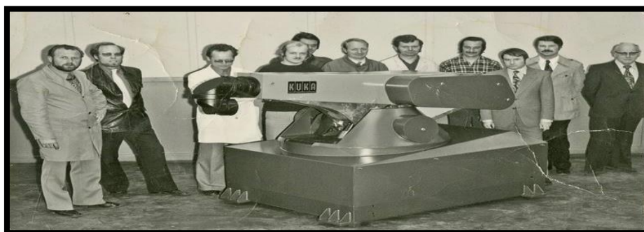
Figure I.3 : FAMULUS, le premier robot industriel à commande entièrement électrique.
