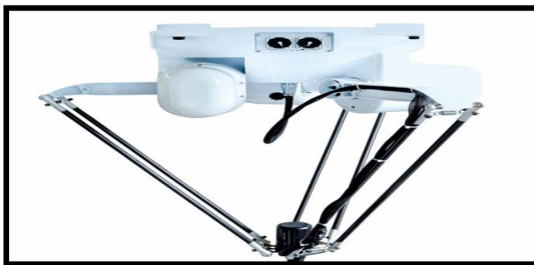
Figure I.11 : robot parallèle de type Delta en pleine action
