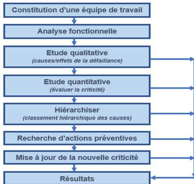
Figure 2.3 : La démarche d'une AMDEC [20]
