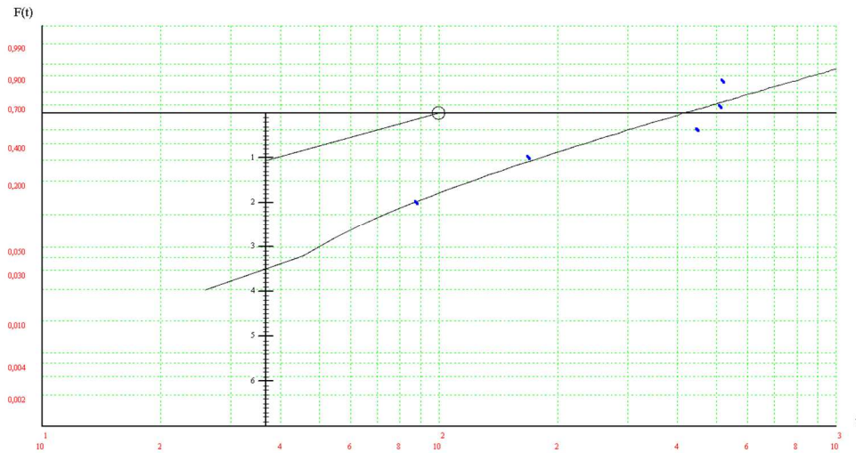
Figure 4.6. Représentation des TBF sur le papier de Weibull
