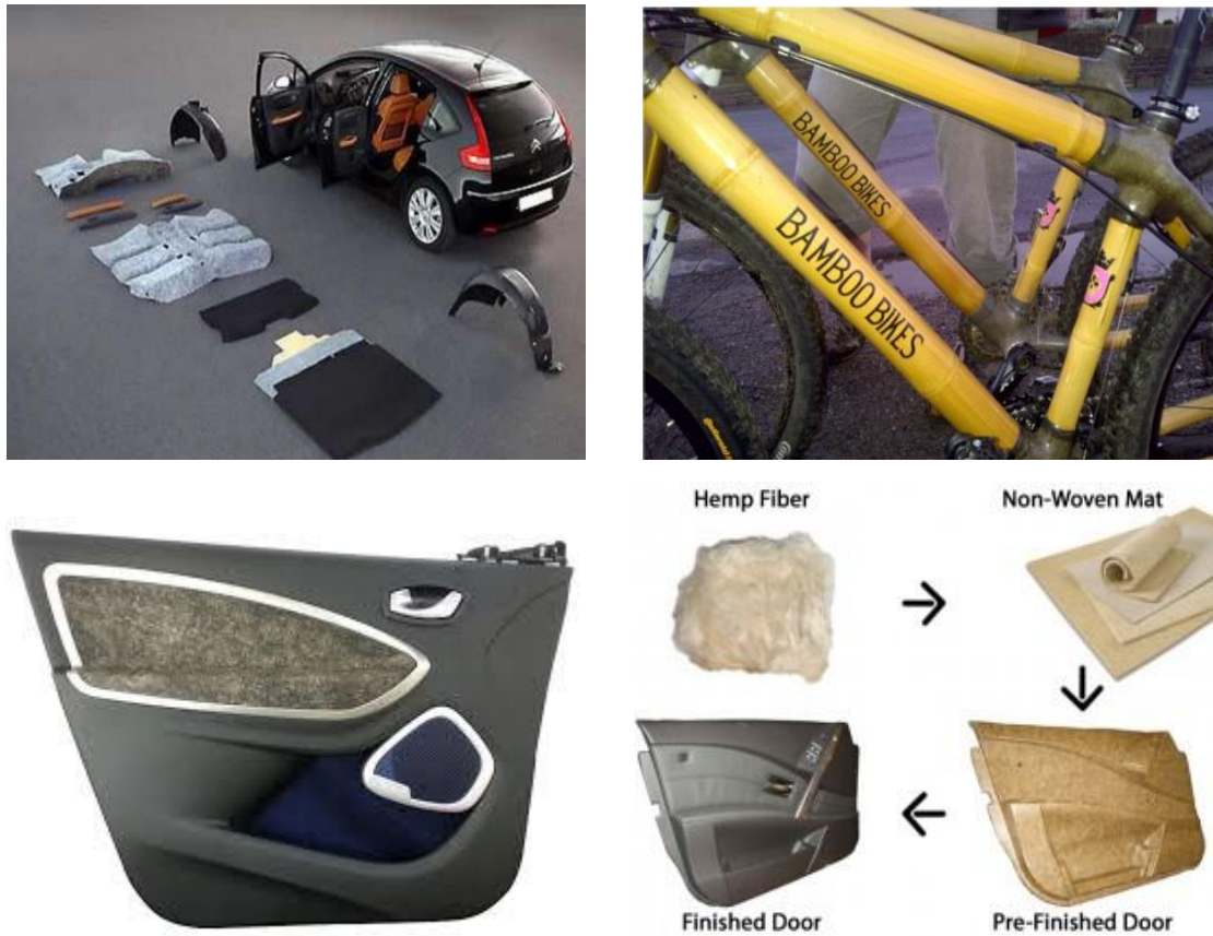
Figure I.7 : Application des matériaux composites à base de fibres naturelles dans le domaine d'automobile [20].
