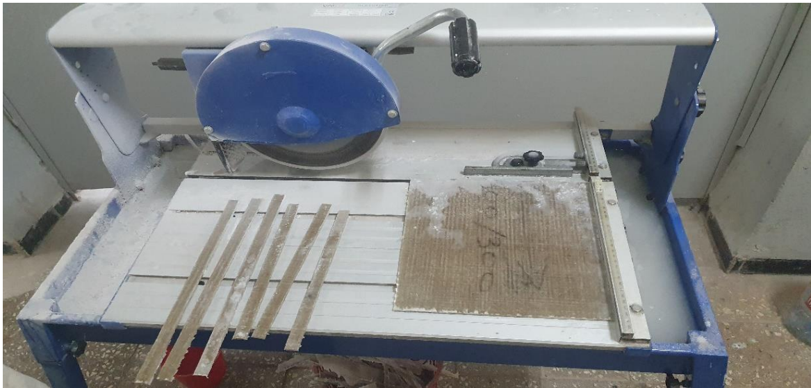
Figure II.8 : Tronçonneuse à disque diamanté utilisée pour le découpage des plaques composites et de résine en éprouvettes.
