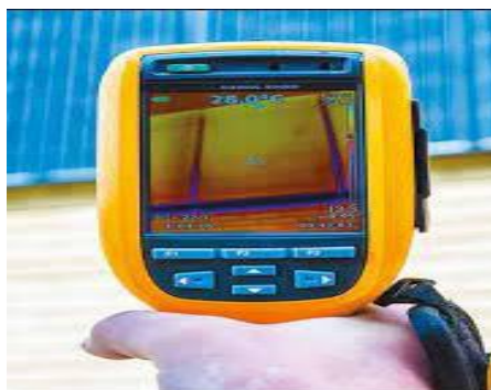
Figure 2.6 : Méthode de l'imagerie numérique infrarouge thermique
