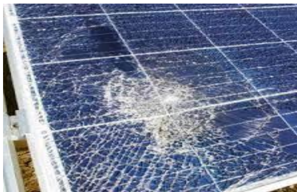
Figure II. 6: Fissures dans les cellules PV [23]
