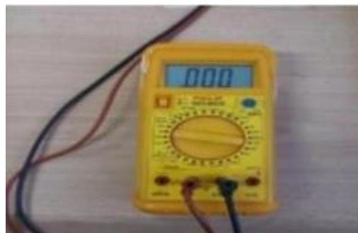
Figure II.6 Multimètre numérique utilisé pour la mesure du courant de décharge.
