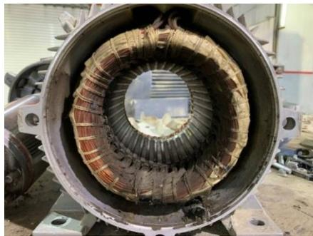
**Figure1.2** Vue du stator bobiné avec ses enroulements
