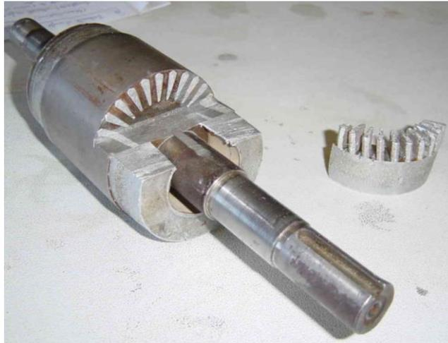
**Figure1.3** Coupé d'un rotor en Cage d'Écureuil
