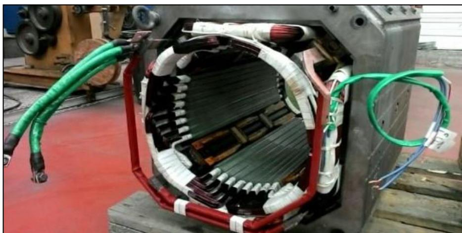
Figure I.2: L'inducteur de la machine à courant continu
