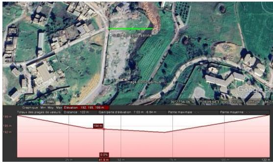
**Figure IV.12** Coupe transversale de terrain
