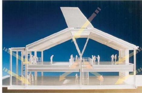
*Figure I. 2 Illustration de la pénétration de la lumière du jour à travers un modèle réduit (Derek, 2004)*
