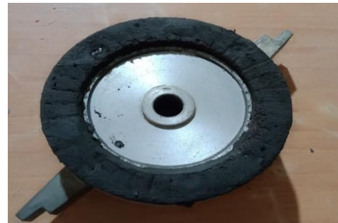
Fig. 4.18 Vue générale du colmatage par le sol En contact qui se manifeste au niveau des rainures Fig. 4.19 Vue générale du colmatage complet par le sol en contact pour S4 Et la surface lisse entre elles pour S3.
