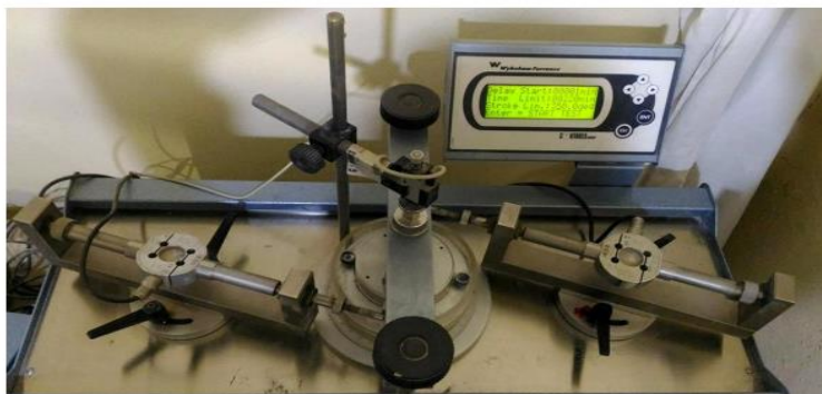
Fig. 3.5 (a) Vue d'ensemble de l'appareil de Bromhead, avec les anneaux de confinement (b) Plateau supérieur et plateau inférieur + conteneur
