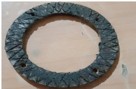
Fig. 4.18 Vue générale du colmatage par le sol En contact qui se manifeste au niveau des rainures Fig. 4.19 Vue générale du colmatage complet par le sol en contact pour S4 Et la surface lisse entre elles pour S3.
