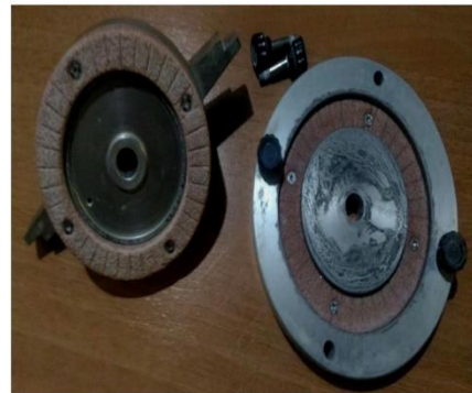
Fig. 3.5 (a) Vue d'ensemble de l'appareil de Bromhead, avec les anneaux de confinement (b) Plateau supérieur et plateau inférieur + conteneur
