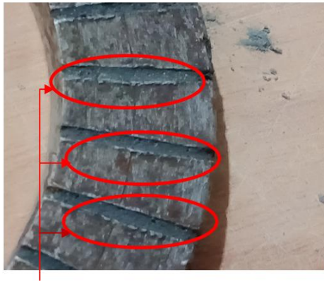
Fig. 4.20 Vue générale des bords tranchants S1
