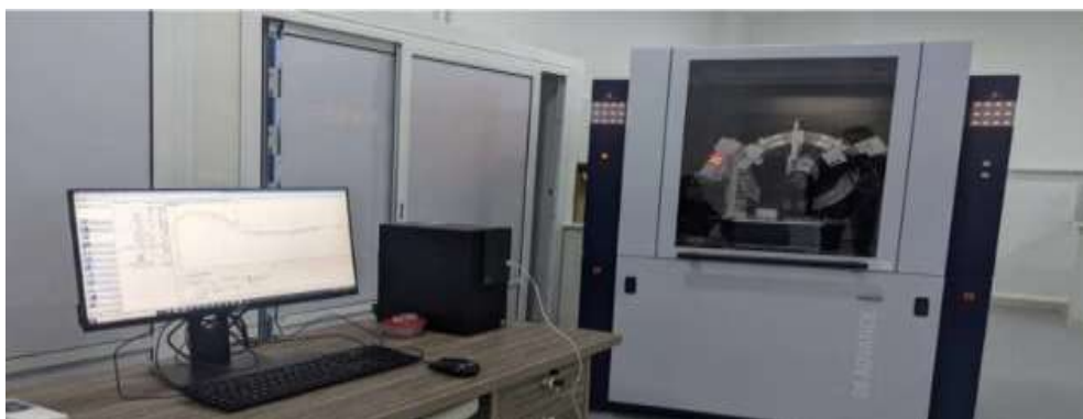
Fig. 10: Photographie numérique du diffractomètre ADVANCE BRUKER D8 utilisé pour la caractérisation du composite à étudier.
