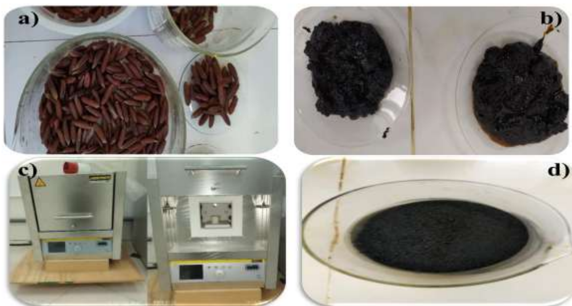
Fig. 4: a) Noyaux des dattes après lavage et séchage, b) Les noyaux après activation avec du H_2SO_4 , C) Pyrolyse dans le four à moufle, d) Charbon actif après pyrolyse
