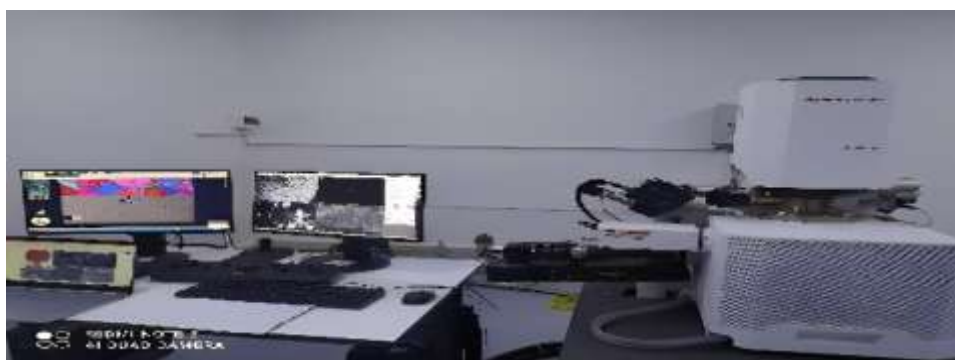
Fig. 11 : Photographie numérique d'un MEB-FEG Quattro S utilisé pour analyser la topographie des adsorbants synthétisés dans le cadre de cette étude.
