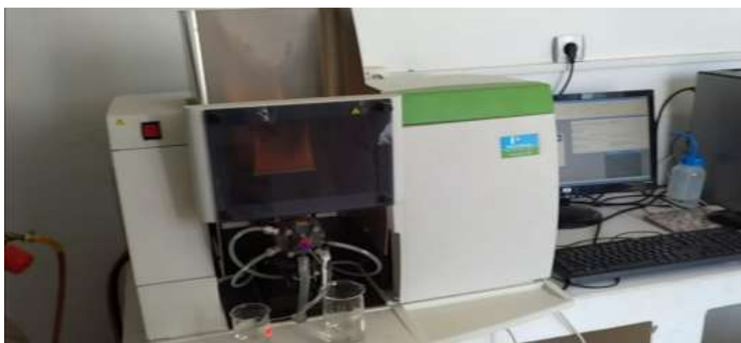
Fig. 13: Photographie numérique de la SAA utilisé pour déterminer la concentration en cadmium.
