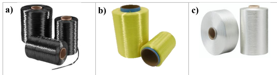
Figure I.14 Différents fibres : a) Fibre de carbone, b) Fibre de KIVLAR et c) Fibre de verre
