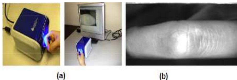
Figure 3.3 : Le système FKP ; (a) le dispositif d'acquisition d'images FKP ; (b) une image FKP acquise par ce système [5].
