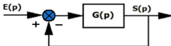
Figure 6.3 : Système asservi à retour unitaire
