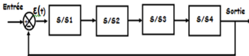
Figure 2.6 : Diagramme fonctionnel d'un système suiveur
