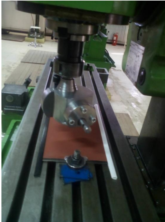
Figure IV. 11 : dispositif de test de frottement monté sur une fraiseuse verticale.
