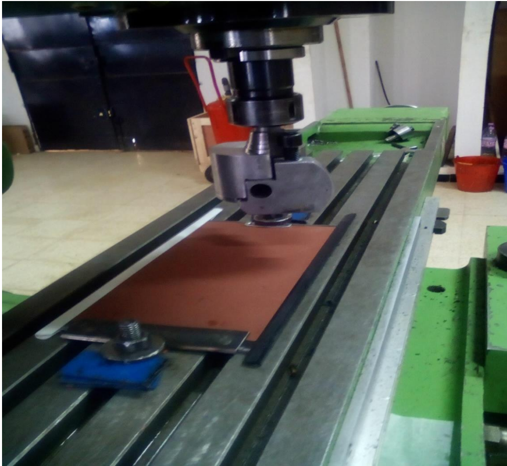
Figure III. 7 : Dispositif des essais de frottement monté sur une fraiseuse verticale.
