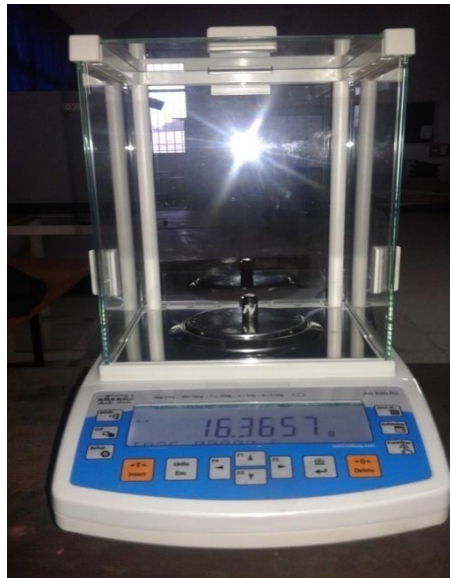
Figure III. 12 : Balance de précision de 10^{-4} g pour mesurer la perte de poids (P).
