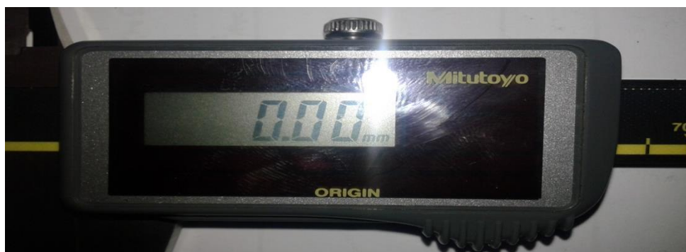
Figure III. 13 : Pied à coulisse digitale pour la mesure de la perte d'épaisseur ( \Delta L ).
