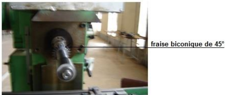
Figure III. 3: Fraiseuse horizontale pour l'usinage de déférents entailles (1.5, 2.5 et 3.5mm).
