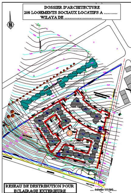
Figure 40: Réseau d'éclairage extérieur
